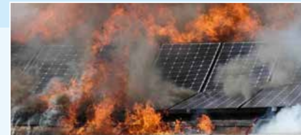
Požár fotovoltaických panelů na střeše rodinného domu
